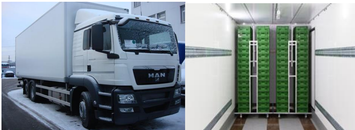
Рисунок 2- Транспортное средство с термоизолированным кузовом для перевозки суточных цыплят на базе шасси МАН-TGS 26.320
