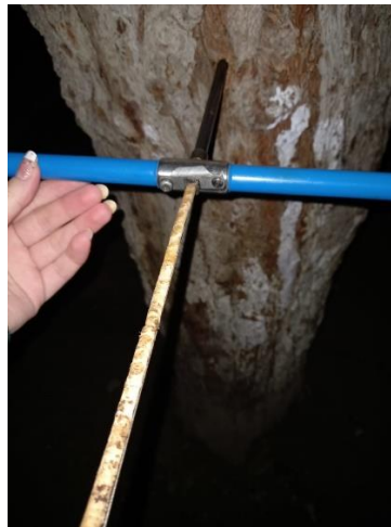
Şəkil 1. Suunto burğusu ilə nümunənin götürülməsi
